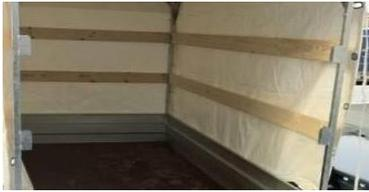
**Holzlatte für Blachenaufbau 116x25mm**
