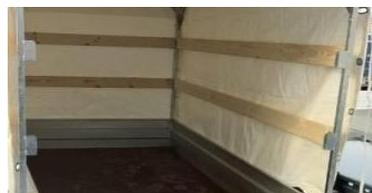
**Holzlatte für Blachenaufbau 116x25mm**
