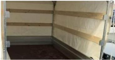
**Holzlatte für Blachenaufbau 116x25mm**
