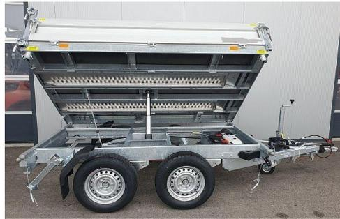
Rampen in Rampenfach Kurbelstütze
