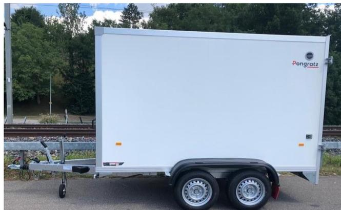
Tandemachser, verzinktes Fahrgestell mit V-Deichsel, automatisches Stützrad, Auflaufbremsen mit Rückfahrautomatik, Gummifederachsen. Beleuchtung 12 Volt mit 13-poligem Stecker, 2 Radkeile. Für 100km/h zugelassen.
