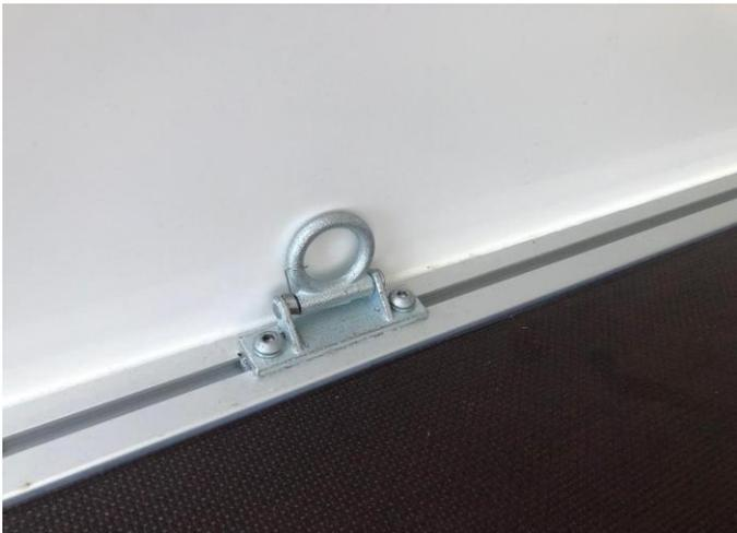
Links und rechts je eine Profilschienen mit je 4 verstellbaren Bänderinge
