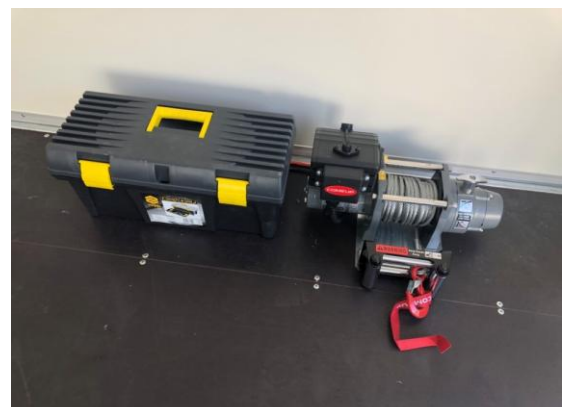
Elektro-Seilwinde am Boden montiert
