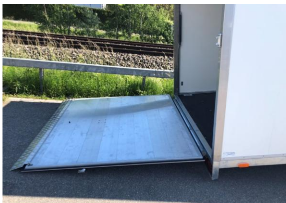
Rampe mit Überfahrblech am Rampenende Änderungen vorbehalten
