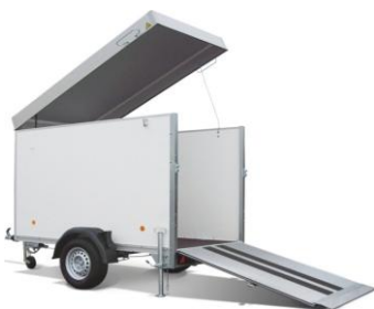
KT-2513/135K Plywoodwände, Aludach hochklappbar, Rampe mit Antirutschbelag
