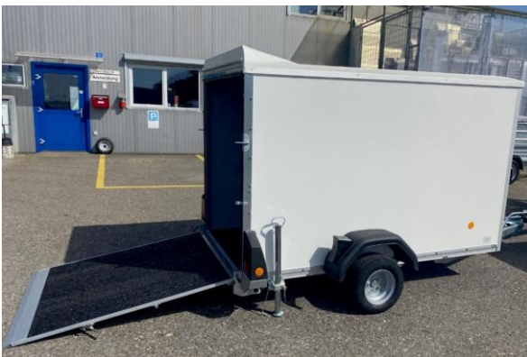
KT-2513/135 F Niederfahrwerk 10"-Bereifung, Kombirampe, Ladehöhe ca. 35cm
