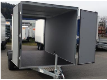
Fronttüren für das Durchladen zum Fahrzeug
