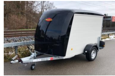
KT-PB-AL Aluminiumwände, Polyesterbug + Polyesterdach, Kombirampe (Rampe auch als Türe zu öffnen)
