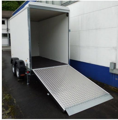
KT 3015/H Rampe mit Aluriffelblech
