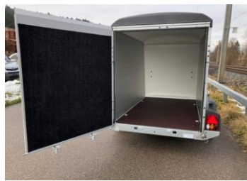
KT Kombirampe Plywoodwände, Polyesterdach Kombirampe, Rampe auch als Türe zu öffnen
