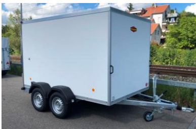
KT Plywoodwände Polyesterdach Flügeltüren
