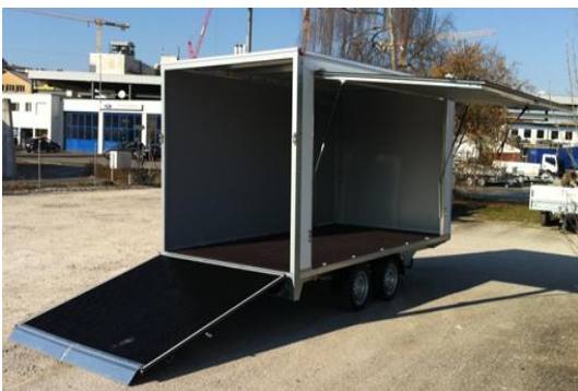
Rutschfester Silikonbelag, Anfahrblech, Seitenklappe
