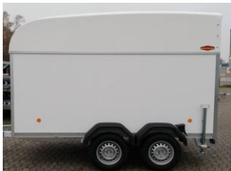
KT-P Plywoodwände hohes Polyesterdach Flügeltüren
