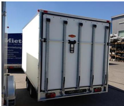
Hochlader mit Heckrampe, Hebehilfen
