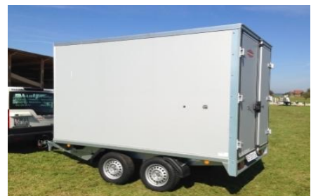
KH Hochlader Plywoodwände, Alu- oder Sandwichdach
