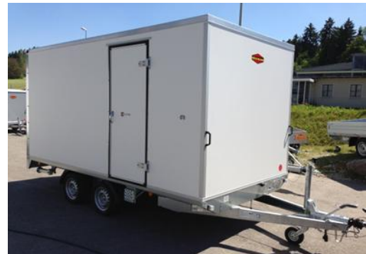
Hochlader mit Seitentüre und Klapptritt
