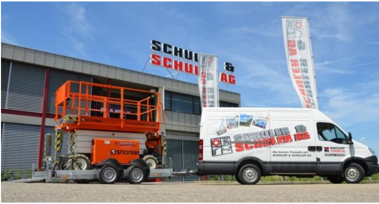
Scherenbühne mit Eigengewicht von 2700kg auf Absenker FB 35.35, 345 x 162 x 10cm GG 3500kg mit Alurampe
