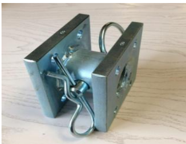
Schwenkvorrichtung für Stützräder, belastbar bis 500kg, schwenkbar um 90°, feuerverzinkt. Grundplatte 100x100mm, Dicke 12mm. Lochabstand 50x70mm, Lochdurchmesser 10,5mm. Dicke der beiden Platten ca. 68mm, Bolzendicke 16mm.
