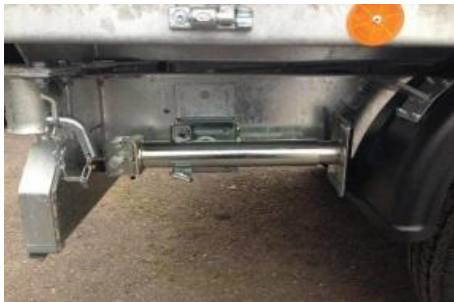
Stützfuss klappbar, Flanschanschluss, Hub 430mm, Traglast 900kg (Preise ohne Flanschplatte Nr. 52220) Miet-Lift Art. Nr. 52219
