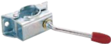
Klemmschelle ø 48mm Knebelschraube starr, verlängerter Knebel Tragfähigkeit max. 200kg
