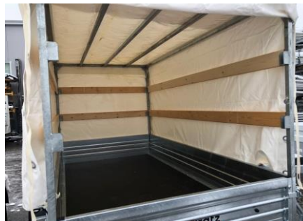
Blachenaufbau, Stahlgestell mit Holzplatten
