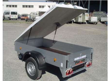
LPA 206 AL mit Polyesterdeckel und Hebehilfe
