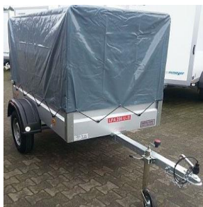
LPA 206 G Innenhöhe 121cm Stirnwand abklappbar
