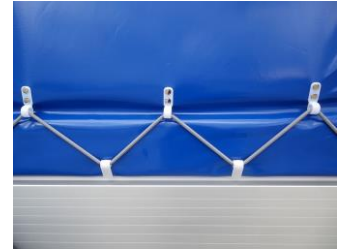
Blachenbefestigung an Bordwand
