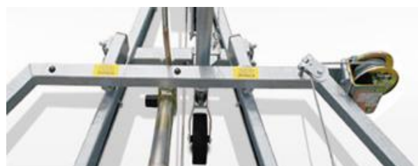
3 Steckmöglichkeiten für Umlenkrolle
