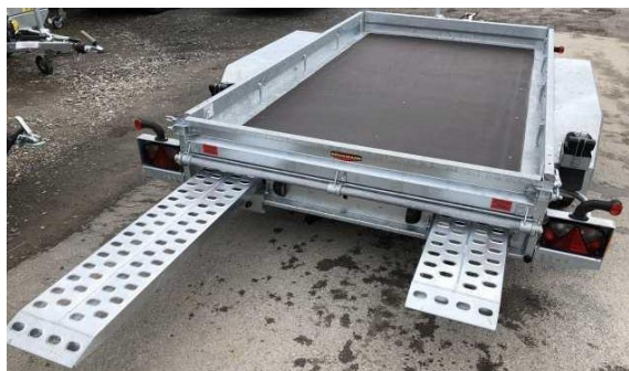
Stahlrampen in Rampenschacht
