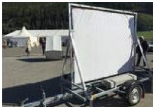
Tieflader 1-Achser, verzinktes Fahrgestell, Stützrad, 4 Rohrschiebestützen. Gummifederachse verzinkt, ungebremst, Beleuchtung 12 Volt im Lichtbalken geschützt, Gestell / Rahmen auf Fahrgestell verschraubt, verzinkt für **Werbeblache 220x182cm**, verschweisst, verzinkt, demontierbar, links und rechts je 1 Betongewicht ä ca. 80kg. Preis ohne Werbeblache/Druck.
