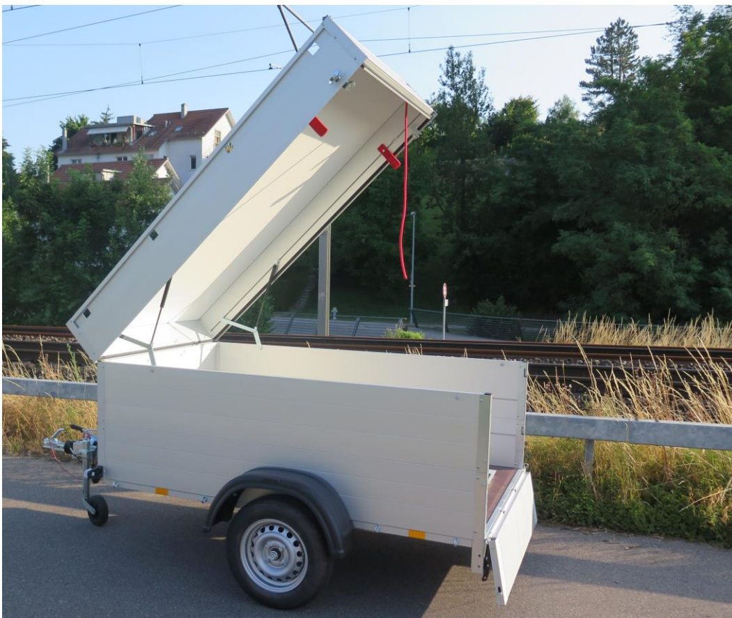
GTB 750 VT1, gebremst 211 x 126 x 83cm, Deckel mit Bindemöglichkeiten
