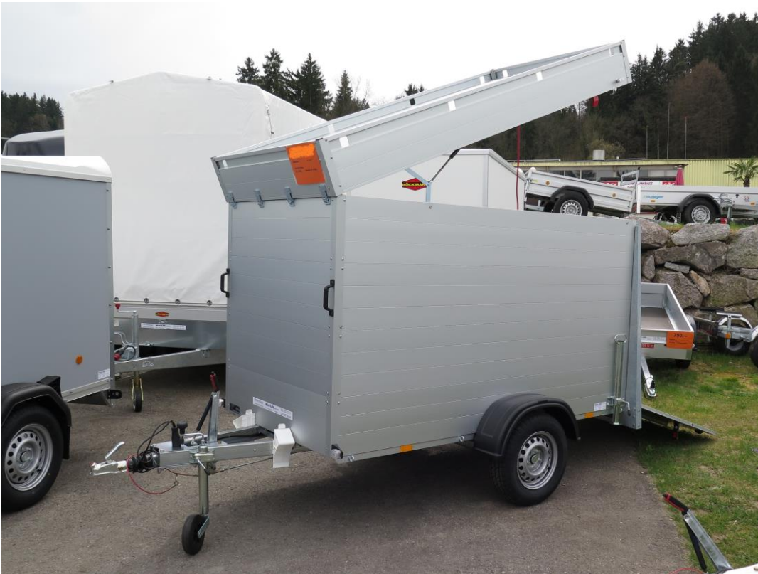
GTB 1200 VT3, gebremst 251 x 126 x 153cm, hinten Auffahrrampe abschliessbar
