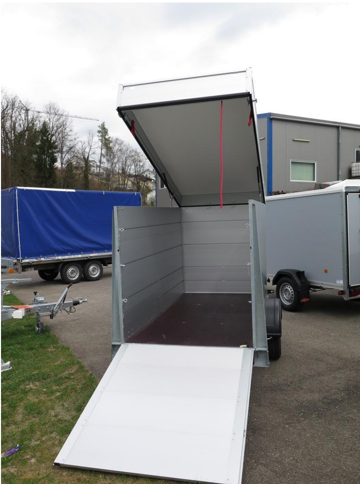
Aufbau Aluminium eloxiert, Auffahrrampe abnehmbar, Schienen für Bänderinge
