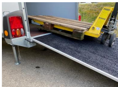
Standardrampe, Überwurfblech am Rampenende
