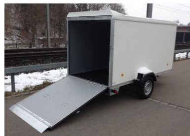
Standardrampe, Überwurfblech am Rampenende
