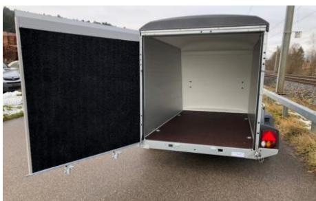
Kombirampe mit Anfahrkeil und Silikon-Antirutschbeschichtung
