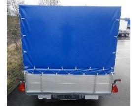
**Hochlader-Multitransportanhänger APHLC** mit Holzboden, 2 Heckschiebestützen, Ladehöhe ca. 62cm/68cm, Alurampen unter Plattform 270x30cm Tragkraft 2500kg/Pair, automatisches Stützrad, Radkeile, Zurringe auf Boden. Kugelkupplung, Auflaufbremse mit Rückfahrautomatik, Gummifederachse verzinkt. Beleuchtung in Lichtbalken geschützt. 12-Volt mit 13-poligem Stecker.
