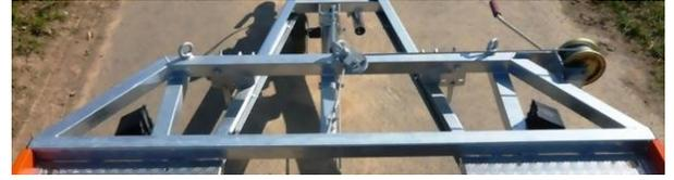
**Kleingeräte- und Autotransporter AP** mit Holzboden, Aluminiumwände, 2 Heckschiebestützen, Winde 900kg, 4 Zurringe auf Boden, Alurampen 220x30cm 2500kg/Pair unter Plattform gelagert, abschliessbar. Kugelkupplung, Auflaufbremse mit Rückfahrautomatik, Gummifederachse verzinkt. Beleuchtung seitlich montiert, 12-Volt, 13-polig.
