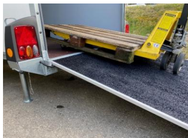
Standardrampe, Überwurfblech am Rampenende
