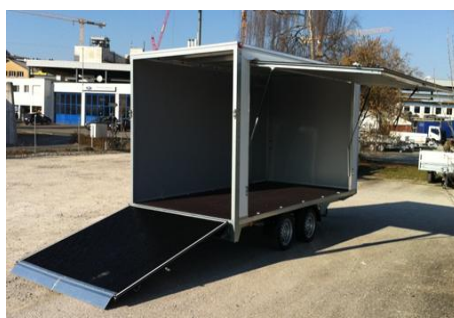
Heckrampe mit Seitenklappe
