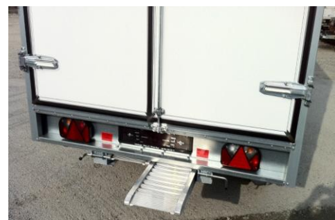
Alurampen unten einschiebbar
