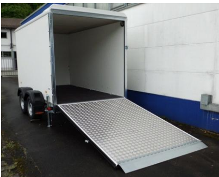
Rampe mit Aluriffelblech
