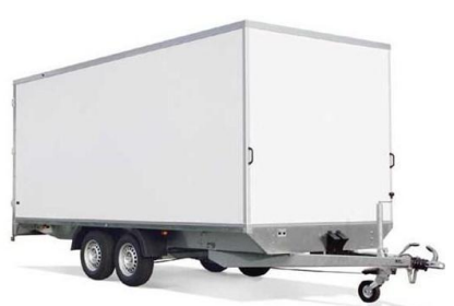
Serie KH Hochlader Plywood-Holzwände Alu- oder Sandwichdach
