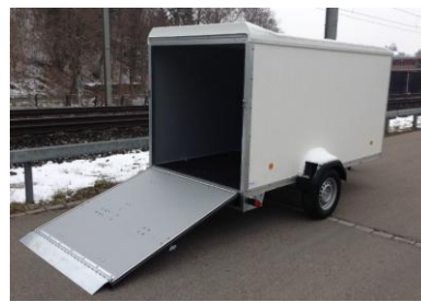
Standardrampe, Überwurfblech am Rampenende
