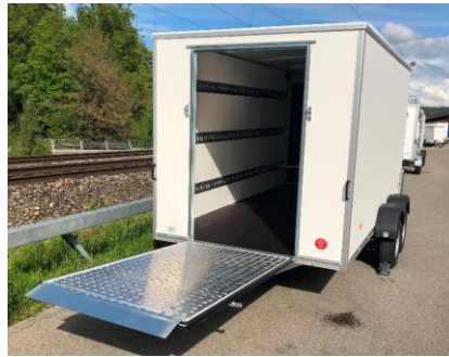
vorne Rampe für Durchladen
