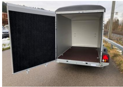
Serie KT Kombirampe Plywood-Holzwände, Polyesterdach Kombirampe, Rampe auch als Türe
