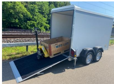
Kombirampe mit Anfahrkeil und Silikon-Antirutschbeschichtung
