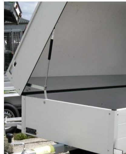
Hebedämpfer für Deckel
