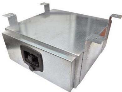
**Werkzeugkiste Metall-Staubbox, abschliessbar** für Montage unter Brücke. Länge 600 x Tiefe inkl. Deckel 600 x Höhe 300mm, Höhe mit Befestigungsbügel/Deckel ca. 350mm, Stahlblech verzinkt, Gummidichtung innen.
