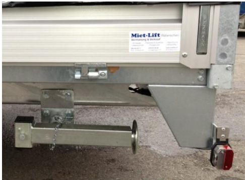
Kurbelstütze, Traglast 1200kg, abschwengbar
