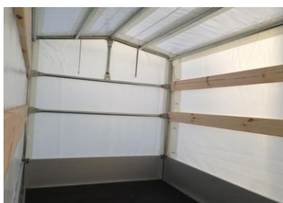
Innenansicht Blachenaufbau Innenhöhe 180cm
