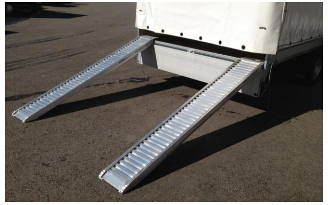
Aluminium-Auffahrrampe (unter Brücke gelagert)
