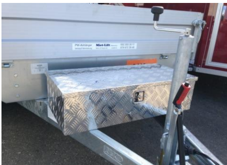
Alubox auf Deichsel montiert
