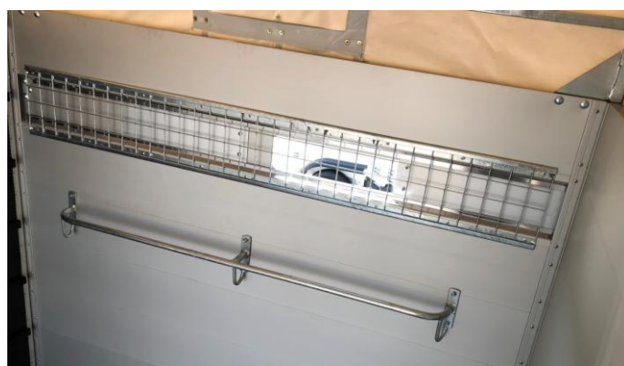
Lüftungsgitter in Stinwand, Innenansicht
