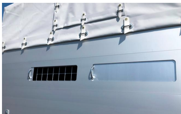
Lüftungsgitter in Stinwand, Aussenansicht
