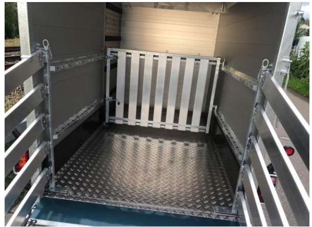
Einachser GG 1800kg, 295 x 140 x 190cm, Vorderausstieg, Kombirampe, Aluboden mit Aluriffelblechwanne Trenngitter 120cm, Treibgitter 120cm, Innenbeleuchtung
