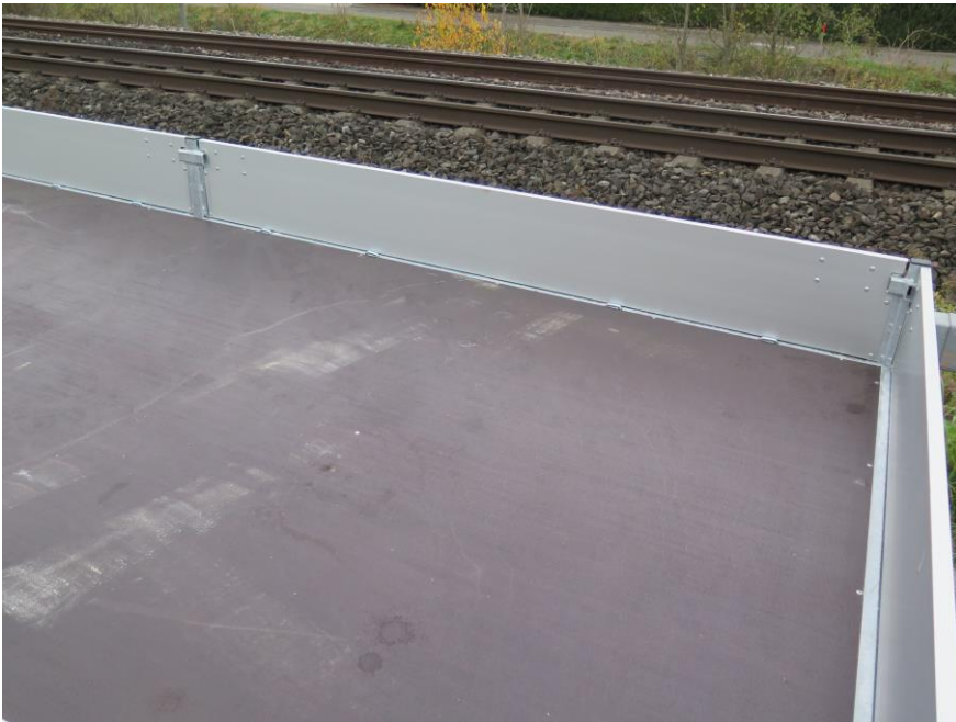
Geteilte Bordwände, Bindebügel in Seitenprofil
