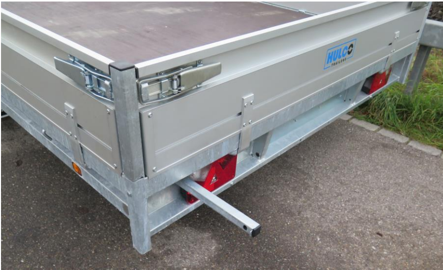
Auszugrohre für das Ablegen der Rückbordwand, versenkte Excenterbordwandverschlüsse
