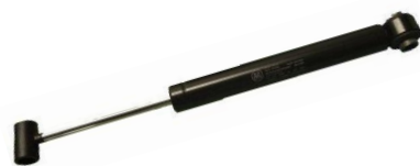
Auflaufdämpfer BPW 1,5 - 2,0 Gesamtlänge 335mm, Länge Loch/Loch 310mm Rohrlänge 175mm, Durchmesser 24mm 02.3722.75.00 / 7417RX Miet-Lift Art.Nr. 53444
