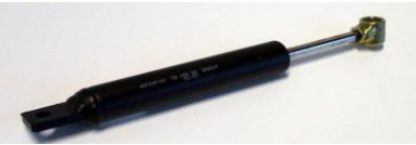
Auflaufdämpfer Peitz, PAV/SR-2.7, Gesamtlänge 235mm, Rohrlänge 155mm, Durchmesser 24mm Miet-Lift Art.Nr. 53425
