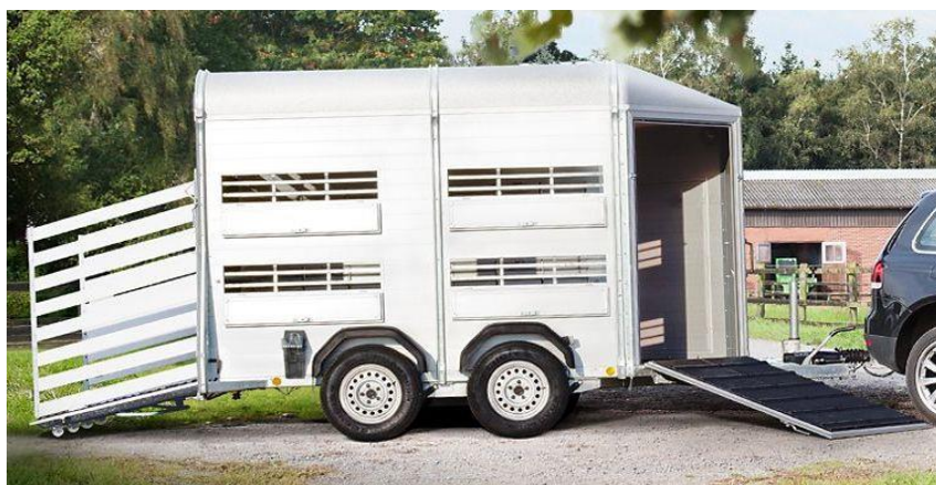
VA 3520 Aluminiumwände, Aluminiumboden, Polyesterhaube
