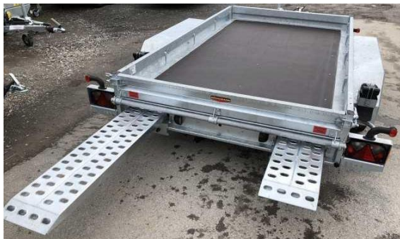
Stahlrampen in Rampenschacht
